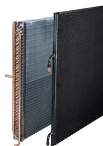
La batterie à microcanaux (à gauche) est plus compacte et plus mince qu'une batterie conventionnelle par plaque à tube rond, et offre une puissance frigorifique supérieure pour un encombrement moindre.
